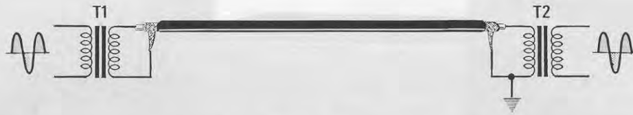
Fig.3 Per evitare queste invisibili "spire" non è mai consigliabile collegare a massa le due estremità della calza metallica, ma un solo estremo. In questo modo il filo interno risulterà perfettamente schermato e non capterà per via induttiva gli eventuali segnali spuri che potrebbero scorrere sulla calza di schermo da un estremo all'altro.
