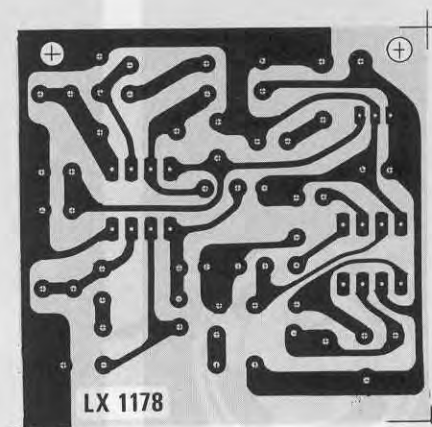
Fig.4 Disegno a grandezza naturale dello stampato LX.1178 visto dal lato rame.
